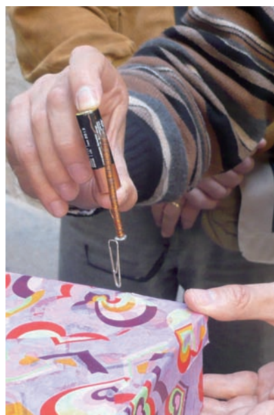
Figura 7. Un clau, uns centímetres de fil de coure i una pila són suficients per fer un electroimant. Aquest punt de trobada dels gironins també és un bon indret perquè diferents disciplines científiques trobin els seus punts de coincidència.
